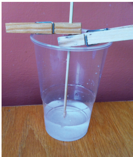
Figura 4 Suspenda o palito de forma que a ponta fique ligeiramente abaixo da superfície da solução
