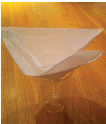
Рисунок 3 Сложенное конусом бумажное полотенце, которое можно использовать в качестве фильтра
